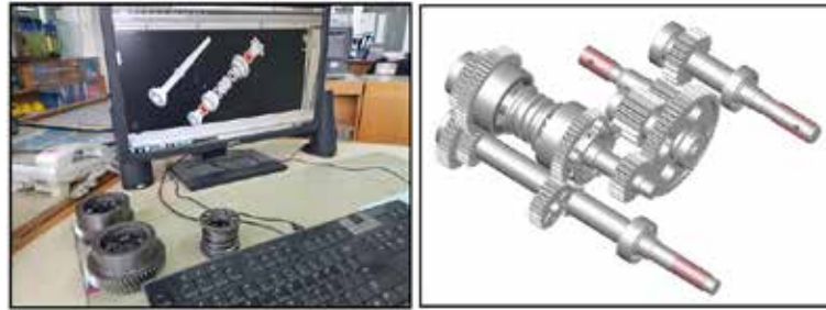
Gambar 6. Pemodelan sistem transmisi gearbox dengan sistem CAD
